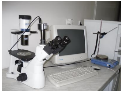
Inverzný biologický mikroskop MBL 3200 od Krüss Optical s kamerovým systémom Video Eypiece VOPE 93, pripojený na počítač – pozorovanie morfológie buniek a určenie ich počtu
