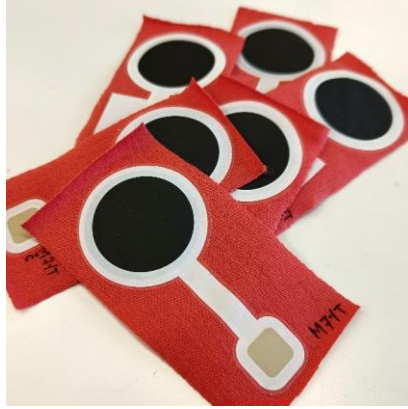
Uhlíkové elektródy pre záznam EKG po prenose na textil pomocou nažehlenia
