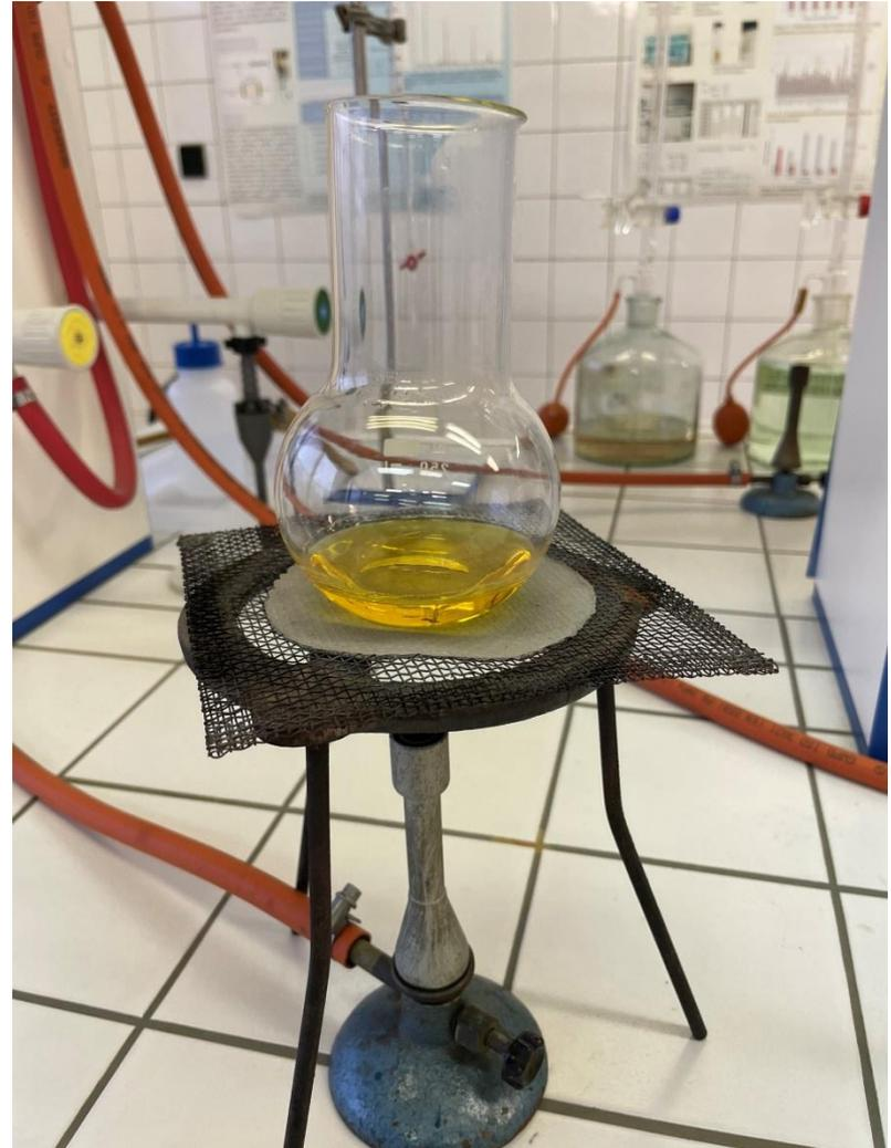
2. U rastvor vrelog žutog uzorka dodati  $\text{SnCl}_2$  kap po kap do obezbojavanja (+2 dodatne kapi). Ovo će redukovati jone  $\text{Fe}^{3+}$  u rastvoru u  $\text{Fe}^{2+}$ .
