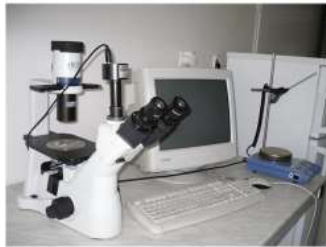
Inverzný biologický mikroskop MBL 3200 od Krüss Optical s kamerovým systémom Video Eypiece VOPC 93, pripojený na počítač – pozorovanie morfológie buniek a určenie ich počtu
